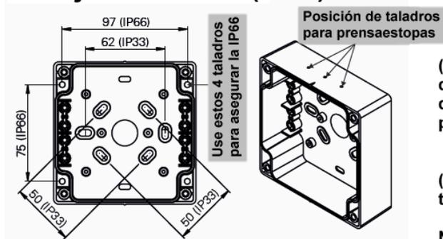
(i) Taladre los orificios necesarios para la fijación del prensaestopas (superior o inferior) y asegúrese de que los cables estén correctamente sellados para garantizar la integridad IP66.
