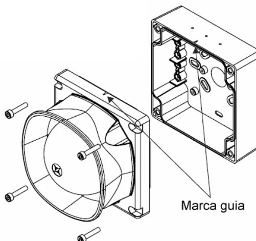
La base permite la entrada del cable para el conexionado tanto desde la parte posterior, como desde la parte superior o inferior mediante prensaestopas. Deben realizarse los taladros necesarios en los puntos habilitados.
